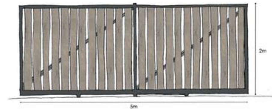
Figure 226 : Portail d'accès en bois ajouré
