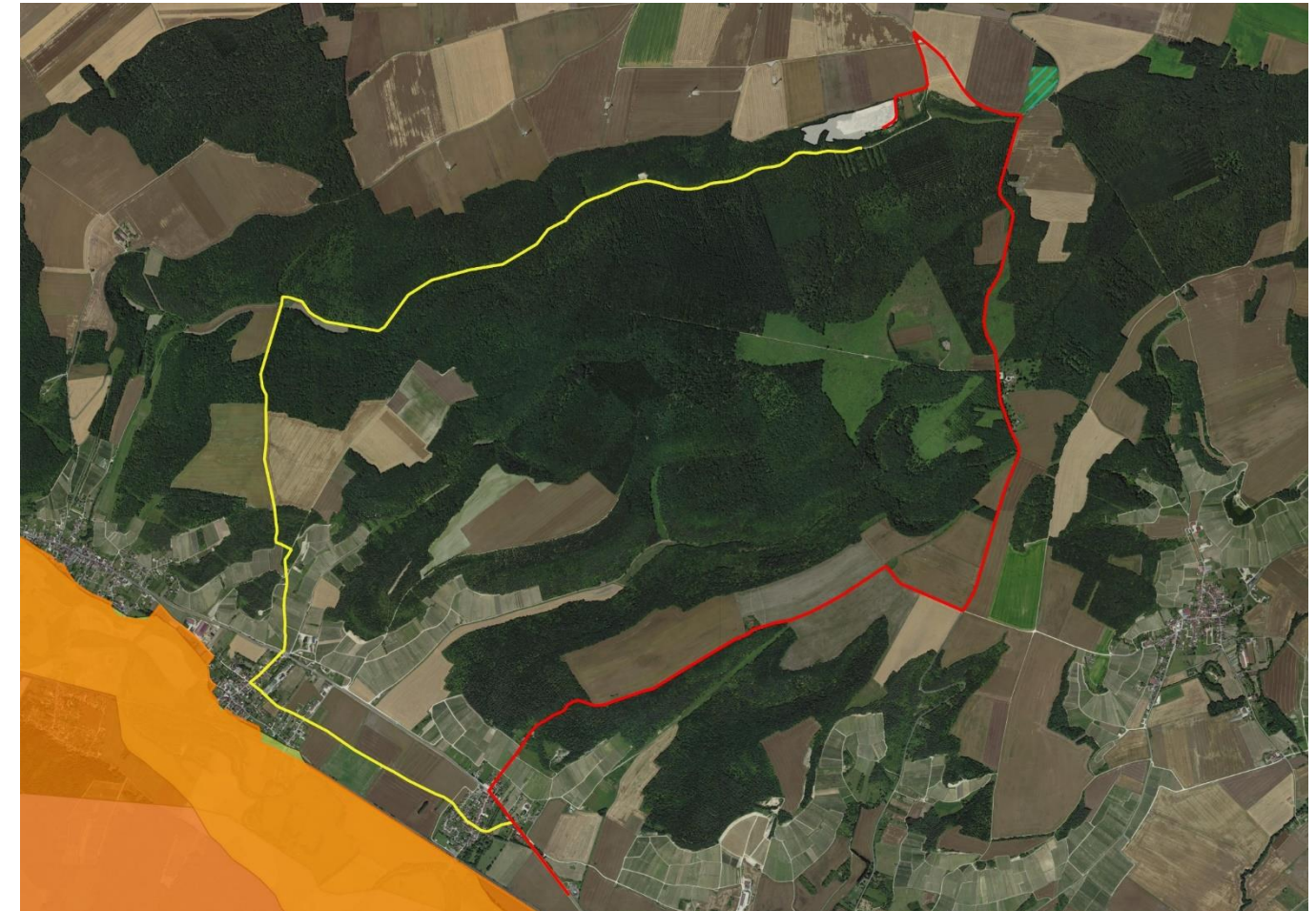
Figure 230 : Tracés envisagés pour le raccordement du projet au poste source électrique d'Ailleville (10) – périmètres espaces protégés en orange, échelle modifiée
